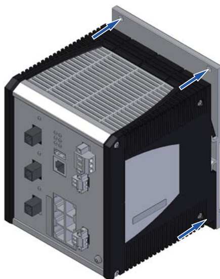
Abb. 2: Gerät (hier: RSR20/RSR30) auf RSR-Wandmontageplatte aufrasten, mit 4 Schrauben an der Wand festschrauben
