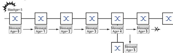
Abb. 37: Übertragung einer STP-BPDU abhängig von MaxAge
