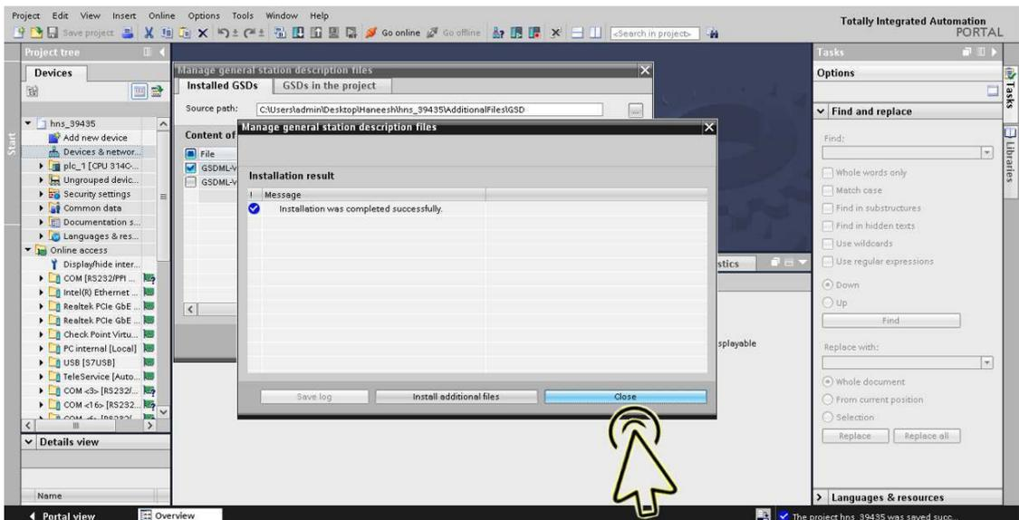
Sie finden das neue Gerät unter den Einträgen *Other field devices > PROFINET IO > Network Components > Hirschmann Automation and Control GmbH*.
