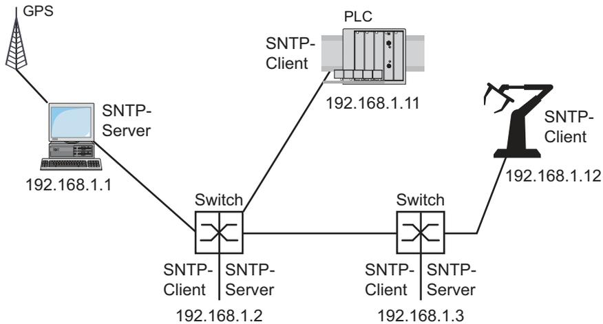
Abb. 18: Beispiel für SNTP-Kaskade
