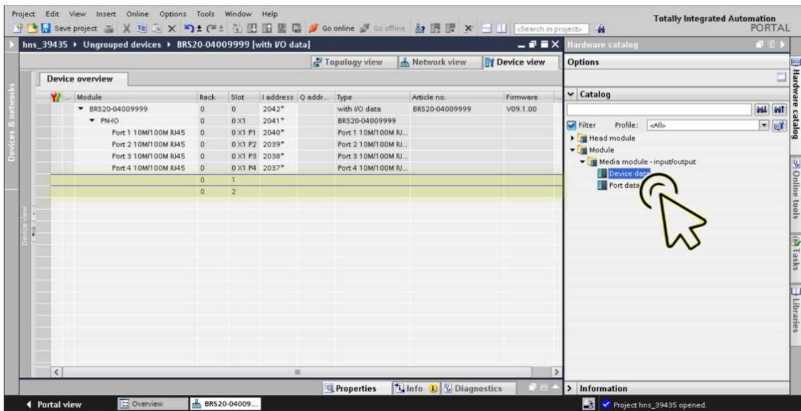
Der Steckplatz, der logisch mit dem Gerät verbunden ist, ist in der Registerkarte *Device view* hervorgehoben.
