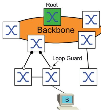
Wenn der Port keine STP-BPDUs mehr empfängt, hilft diese Schutzfunktion, den irrtümlichen Wechsel des Vermittlungsstatus eines Ports auf *forwarding* zu vermeiden. Tritt dieser Fall ein, kennzeichnet das Gerät den Loop-Status des Ports als inkonsistent, leitet aber keine Datenpakete weiter.
