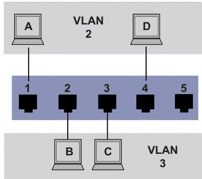
Abb. 25: Beispiel für ein einfaches Port-basiertes VLAN
