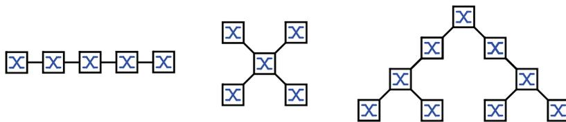
Abb. 27: Netz mit Linien-, Stern- und Baum-Topologie
