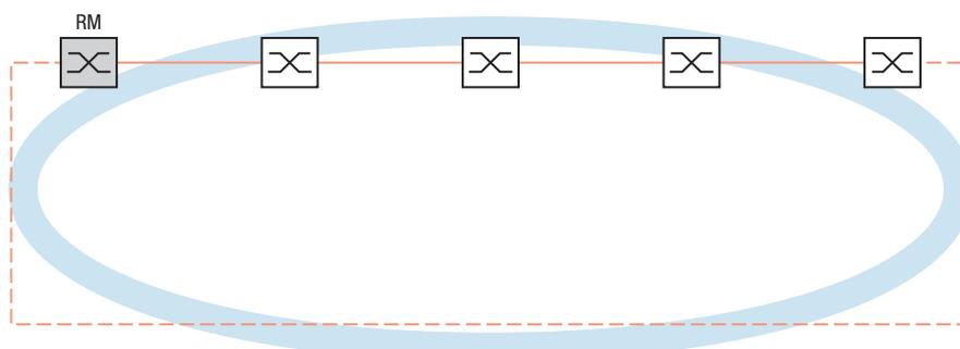
Abb. 31: Redundante Ringstruktur
