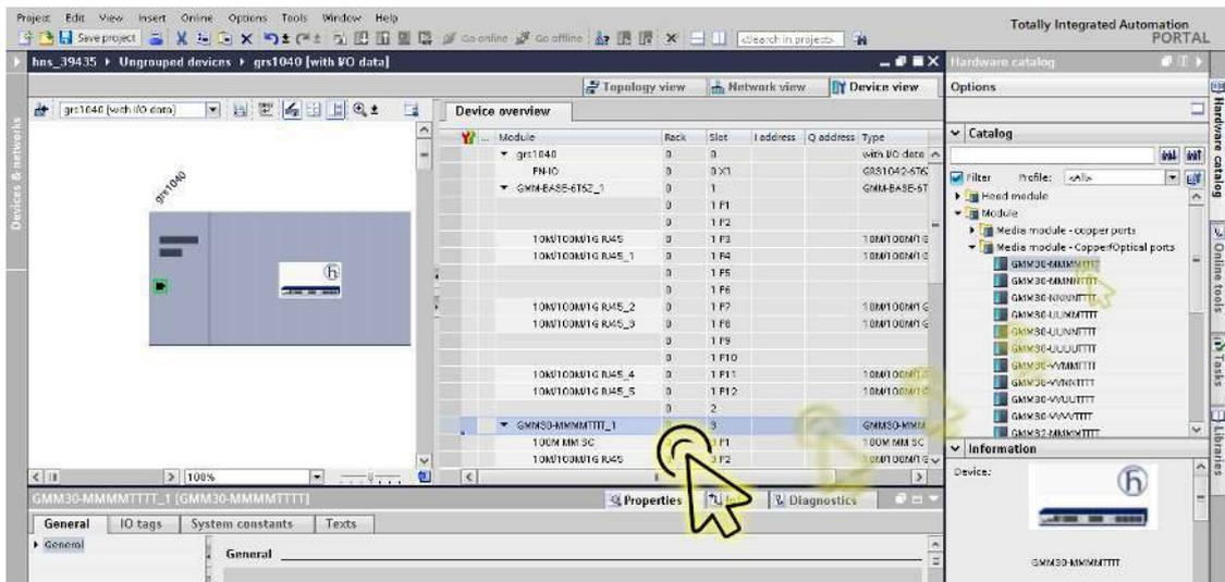
**Anmerkung:** Wenn Sie in der Registerkarte *Device view* ein Modul hinzufügen, fügt das TIA-Portal die *Fixed-Ports* automatisch hinzu. Wenn das Modul über SFP-Steckplätze verfügt, ist das Einrichten der SFPs erforderlich. Siehe Abschnitt „Einen SFP-Transceiver als Untersteckplatz in nicht-modulare Geräte einfügen“ auf Seite 354.
