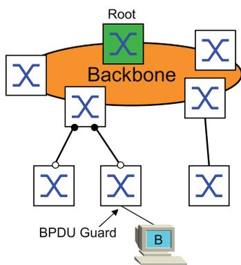
Endgeräte-Ports empfangen im Normalfall keine STP-BPDUs. Versucht ein Angreifer, auf diesem Port trotzdem STP-BPDUs einzuspeisen, deaktiviert das Gerät den Geräte-Port.
