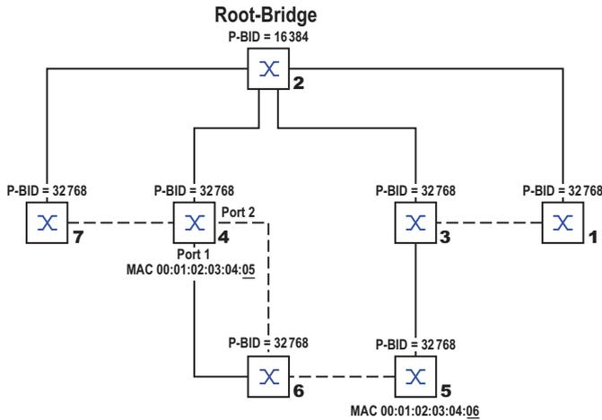
Abb. 41: Beispiel für die Manipulation der Baumstruktur
