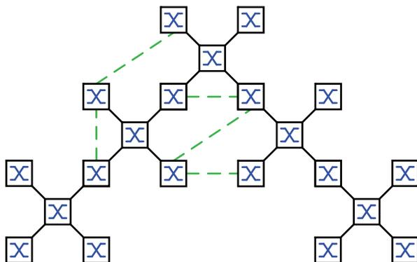
Abb. 28: Maschen-Topologie: Baum-Topologie mit physischen Schleifen
