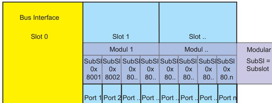
Abb. 56: Modulares Gerät
