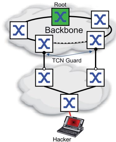
Bei eingeschalteter Schutzfunktion ignoriert das Gerät *Topology Change*-Flags in empfangenen STP-BPDUs. Der Inhalt der MAC-Adresstabelle (Forwarding Database) des Geräte-Ports bleibt dadurch unverändert. Weitere Informationen in der BPDU, die eine Topologie-Änderung bewirken, verarbeitet das Gerät jedoch.
