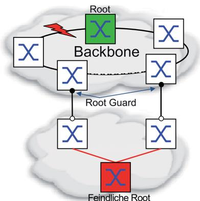
Empfängt ein *Designated-Port* eine STP-BPDU mit besserer Pfadinformation zur *Root-Bridge*, verwirft das Gerät die STP-BPDU und setzt den Vermittlungsstatus des Ports auf *discarding* anstatt auf *root*.
