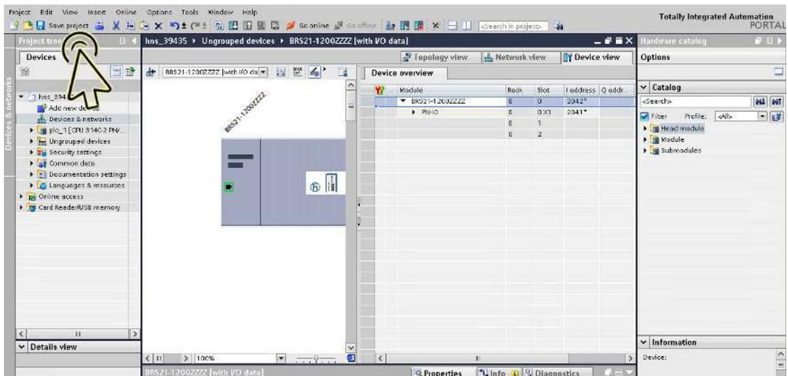
**Anmerkung:** Vergewissern Sie sich, dass der SFP-Untersteckplatz, den Sie im TIA-Portal hinzugefügt haben, und der physisch angeschlossene SFP-Untersteckplatz vom gleichen Typ sind. Andernfalls wird die Applikationsrelation möglicherweise nicht korrekt eingerichtet.
