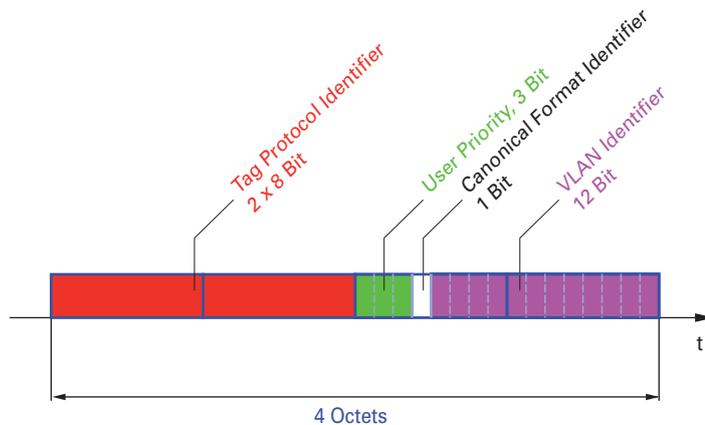
Abb. 23: Aufbau des VLAN-Tag
