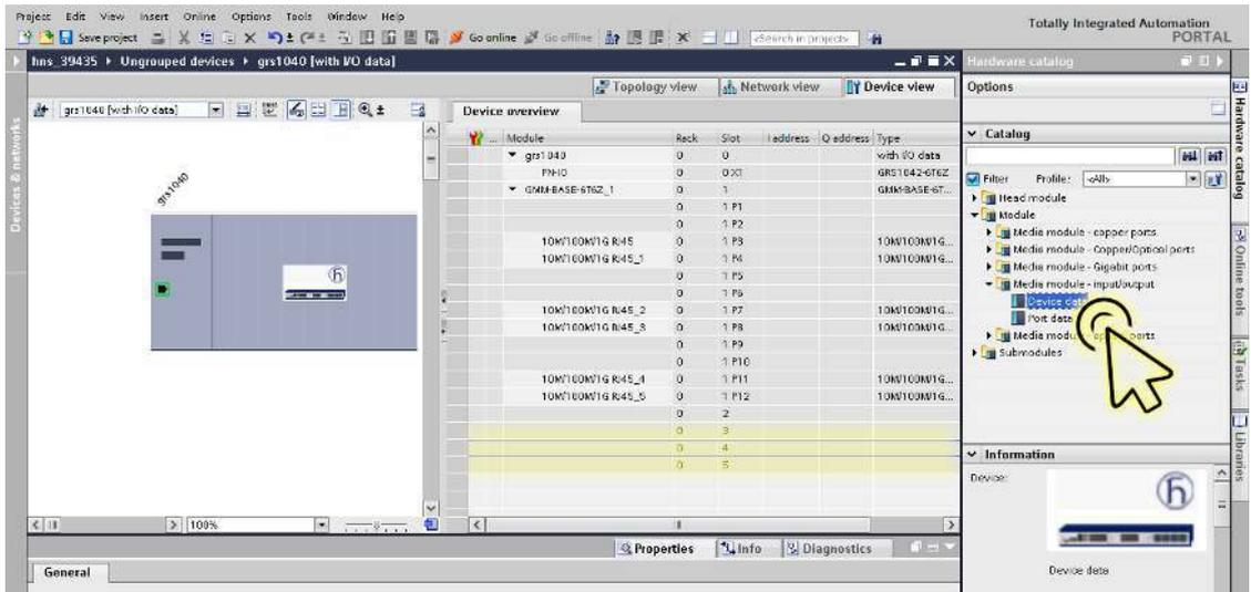
Der Steckplatz, der logisch mit dem Gerät verbunden ist, ist in der Registerkarte *Device view* hervorgehoben.
