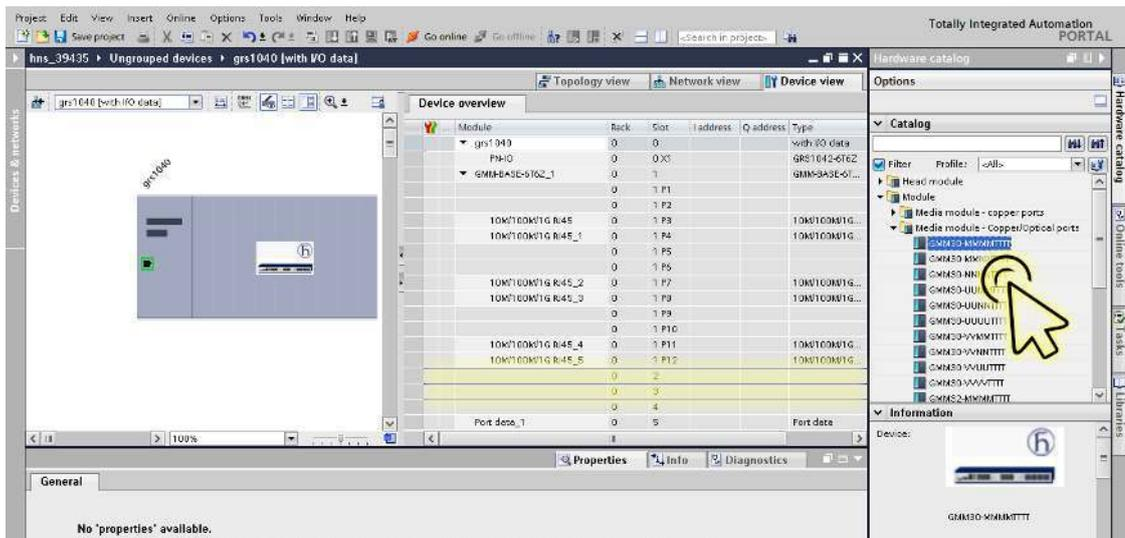
In der Registerkarte *Device view* ist der Steckplatz, der physisch mit dem Gerät verbunden ist, hervorgehoben.
