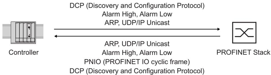
Abb. 54: Kommunikation zwischen Controller und dem Gerät
