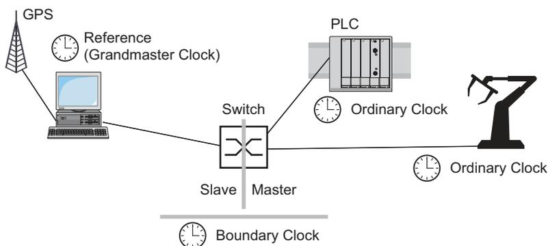
Abb. 19: Position der Boundary-Clock in einem Netz
