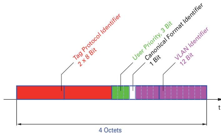
Abb. 33: Aufbau des VLAN-Tag
