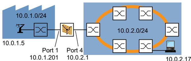
Abb. 22: Anwendungsbeispiel für ein Paketfilter-Setup
