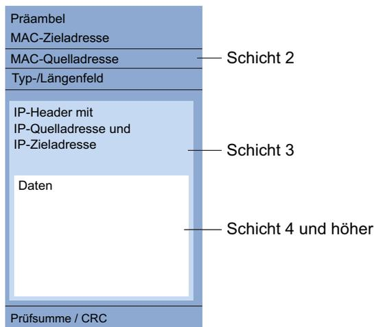
Abb. 40: Aufbau eines Datenpaketes aus Sicht des ISO/OSI-Referenzmodells
