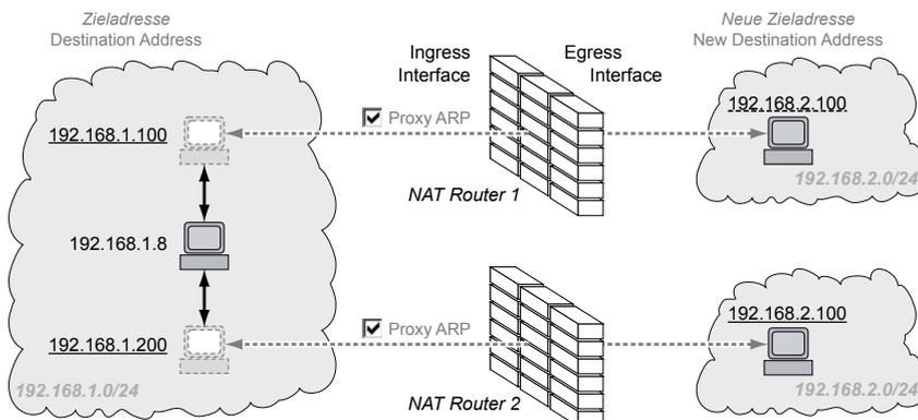
Abb. 50: Identische Produktionszellen mit Leitrechner verbinden (Anwendungsbeispiel)
