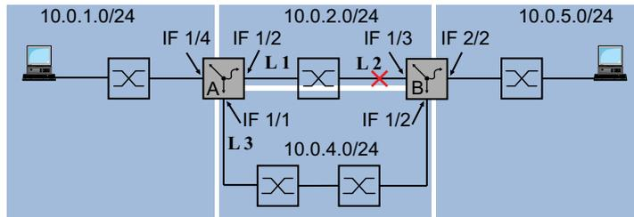
Abb. 71: Statisches Route-Tracking konfigurieren
