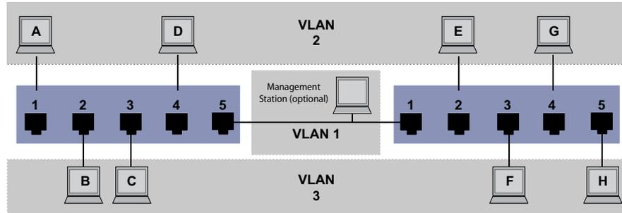
Abb. 36: Beispiel für eine komplexere VLAN-Konfiguration
