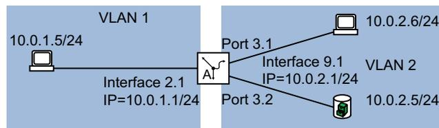
Abb. 45: VLAN-basiertes Router-Interface
