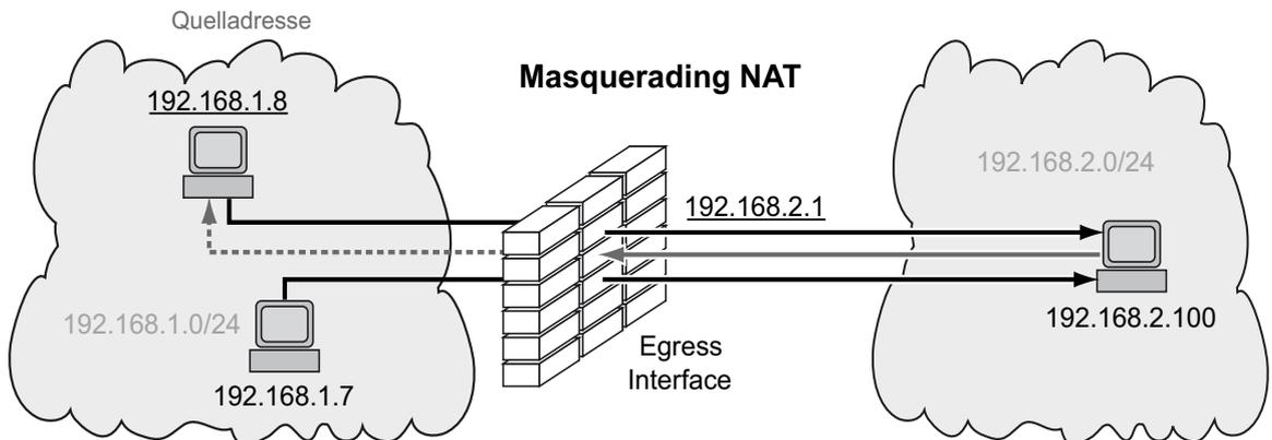
Abb. 7: Funktionsprinzip der Funktion *Masquerading-NAT*
