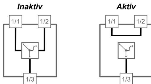
Abb. 20: Zustände des Hardware-LAN-Bypasses
