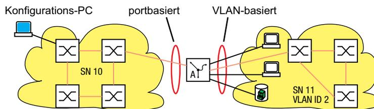
Abb. 43: Statische Routen: Beispiel für eine Verbindung zwischen zwei Fertigungszellen.
