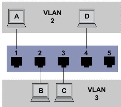
Abb. 35: Beispiel für ein einfaches Port-basiertes VLAN
