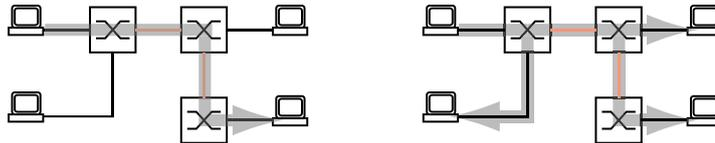
Abb. 38: MAC-Datenvermittlung: Unicast-Datenpaket (links) und Broadcast-Datenpaket (rechts)
