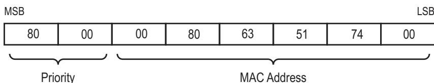
Abb. 28: Bridge-Identifikation, Beispiel (Werte in Hexadezimalschreibweise)
