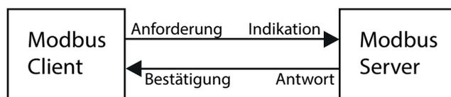
Abb. 132: Modbus TCP/IP Client/Server-Modus
