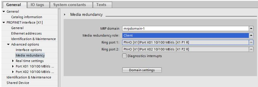
Abb. 48: Beispiel für die Einrichtung eines MRP-Clients im TIA Portal®
