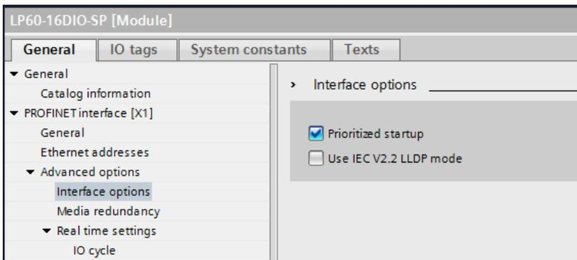
Für eine bessere FSU-Leistung sollten die Übertragungseinstellungen der Anschlüsse X01 und X02 folgendermaßen gesetzt werden:
