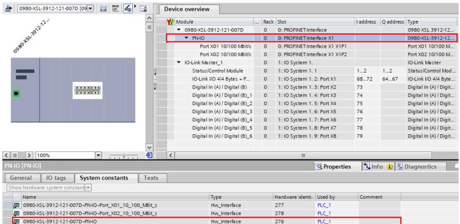
Abb. 50: TIA Portal® Hardware-Identifizierung des PROFINET-Interface für I&M 0-3 RDREC/WRREC
