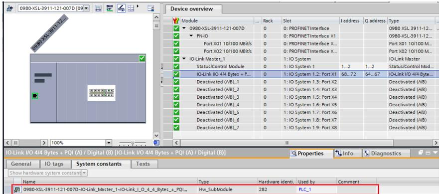
Abb. 52: Hardware-Identifizierung des Status-/Kontroll-Moduls für RDREC "IO System 1.2"
