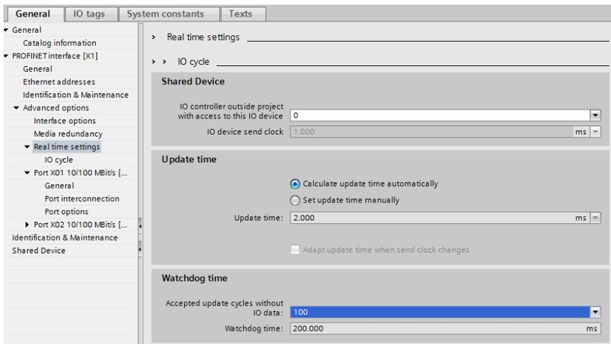
Abb. 49: Beispiel für die Einrichtung der Watchdog-Zeitüberwachung im TIA Portal® für die Nutzung von MRP
