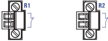
Abb. 5: Signalkontakt: 2-poliger Klemmblock mit Schraubverriegelung
