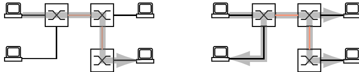
Abb. 30: MAC-Datenvermittlung: Unicast-Datenpaket (links) und Broadcast-Datenpaket (rechts)
