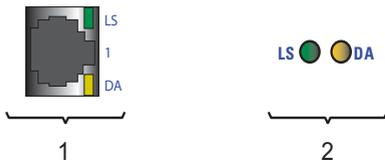
Figura 9: LEDs do estado da porta
