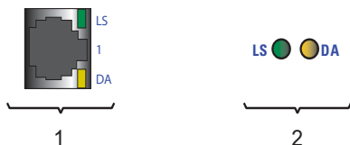
Figura 9: LED stato porta 1 – LED stato porta per RJ45 2 – LED stato porta per DSC
