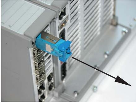
*Figure 19 :Désinstallation du module SFP*
