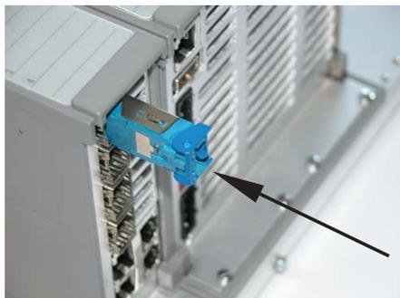
Figure 11 :Installation du module SFP
